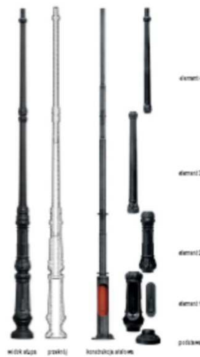
Przekład budowy słupa S-40 W
