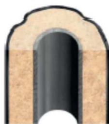
konstrukcja stalowa pianka polimerowa powłoka zewnętrzna z tworzywa sztucznego
